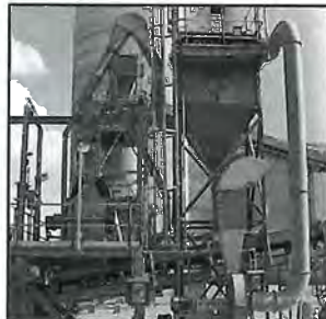
มุดเฉียงท่อที่ถูกต้องและช่องอลดความเร็วลมป้องกันการสีกกร่อนและ mat. ตกค้าง
