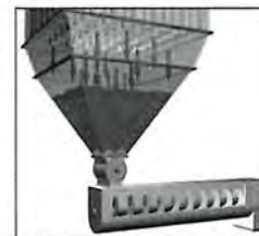
Fig. 1: mat. เหนียวทำให้หลุดดินหรือช่องที่ออกแคบเกินไป
