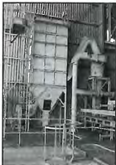
ติดตั้ง cyclone ดักฝุ่นร้อนก่อนเข้าตัว Bag filter
